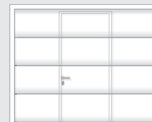
Symmetrische plaatsing bij DB 2.000 - 3.500 mm – alleen in het midden
